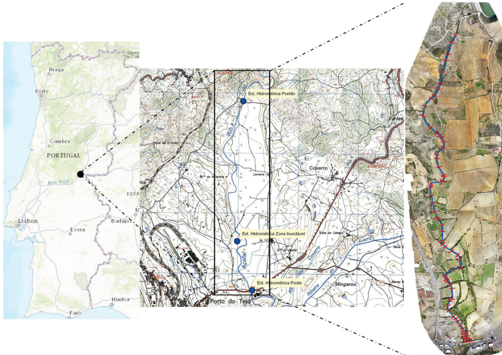
Figura 1 – Área de estudo, localização das três estações de monitorização de altura de água e das 62 secções transversais da ribeira do Açafal levantadas topograficamente.
