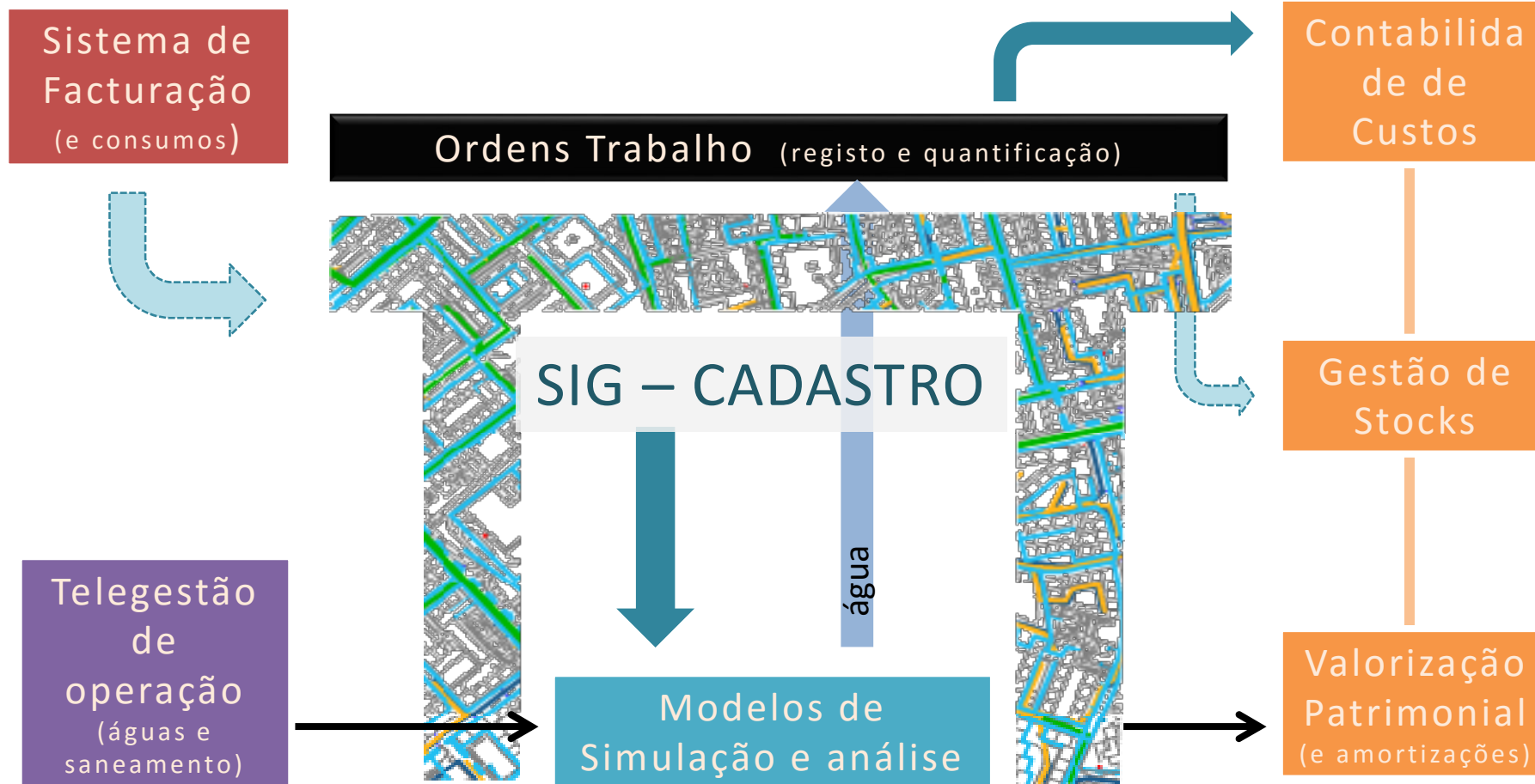
Esquema - Sistemas de Informação de suporte, infraestruturas de Águas, Saneamento e Resíduos
